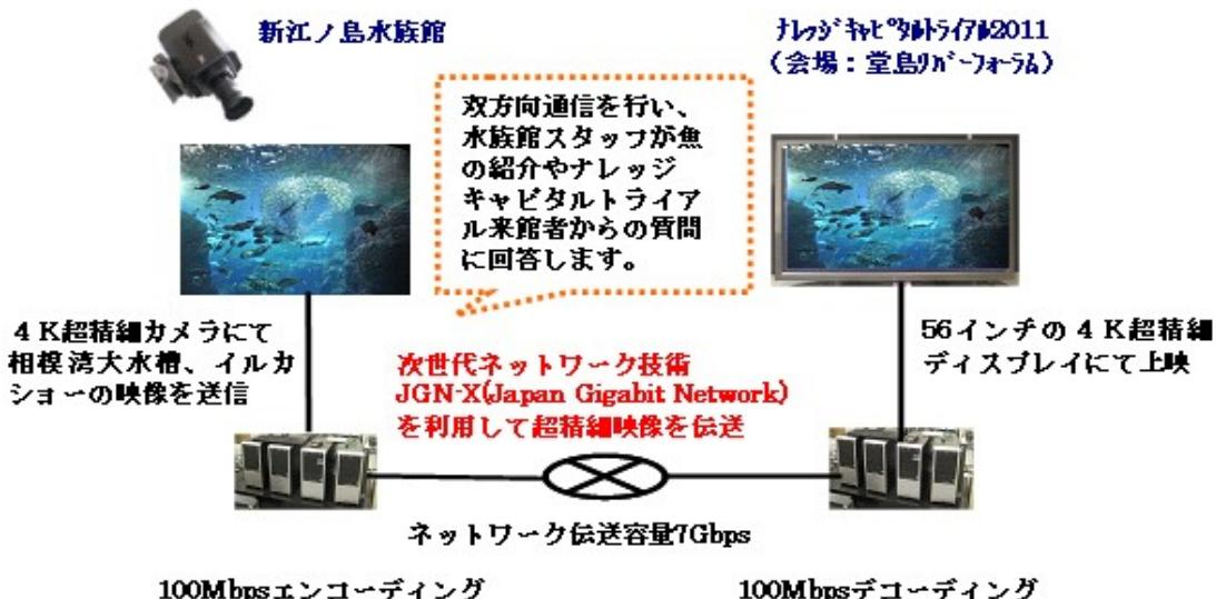
4K超高精細映像は3Dデジタルシネマとして映画の利用が始まっており、その迫力と美しさは、その場にいるかのような感覚にとらわれるリアルな映像で、これまでの高画質映像のイメージを劇的に変えるものです。しかしながら、大容量のため、一般的のインターネット環境でこの超高精細映像の伝送は実現できていません。4K超高精細映像の伝送技術研究は世界的に見ても日本が先行しており、今まさに実用化の段階を迎えようとしています。今回の次世代ネットワーク技術の利用により、4K超高精細のリアルタイム映像を安定的に伝送しライブ中継することが可能になり、エンターテイメント施設の映像を遠隔地で楽しむなど多様な利用形態が期待できます。
