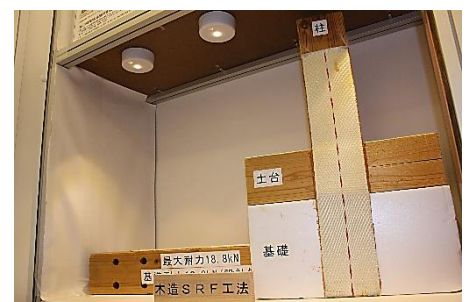
SRF工法は木材にも使用できます
